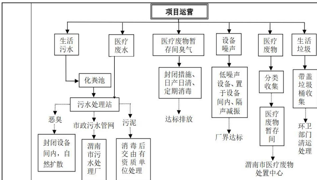
图 2-6 运营期工艺流程及产污环节图
