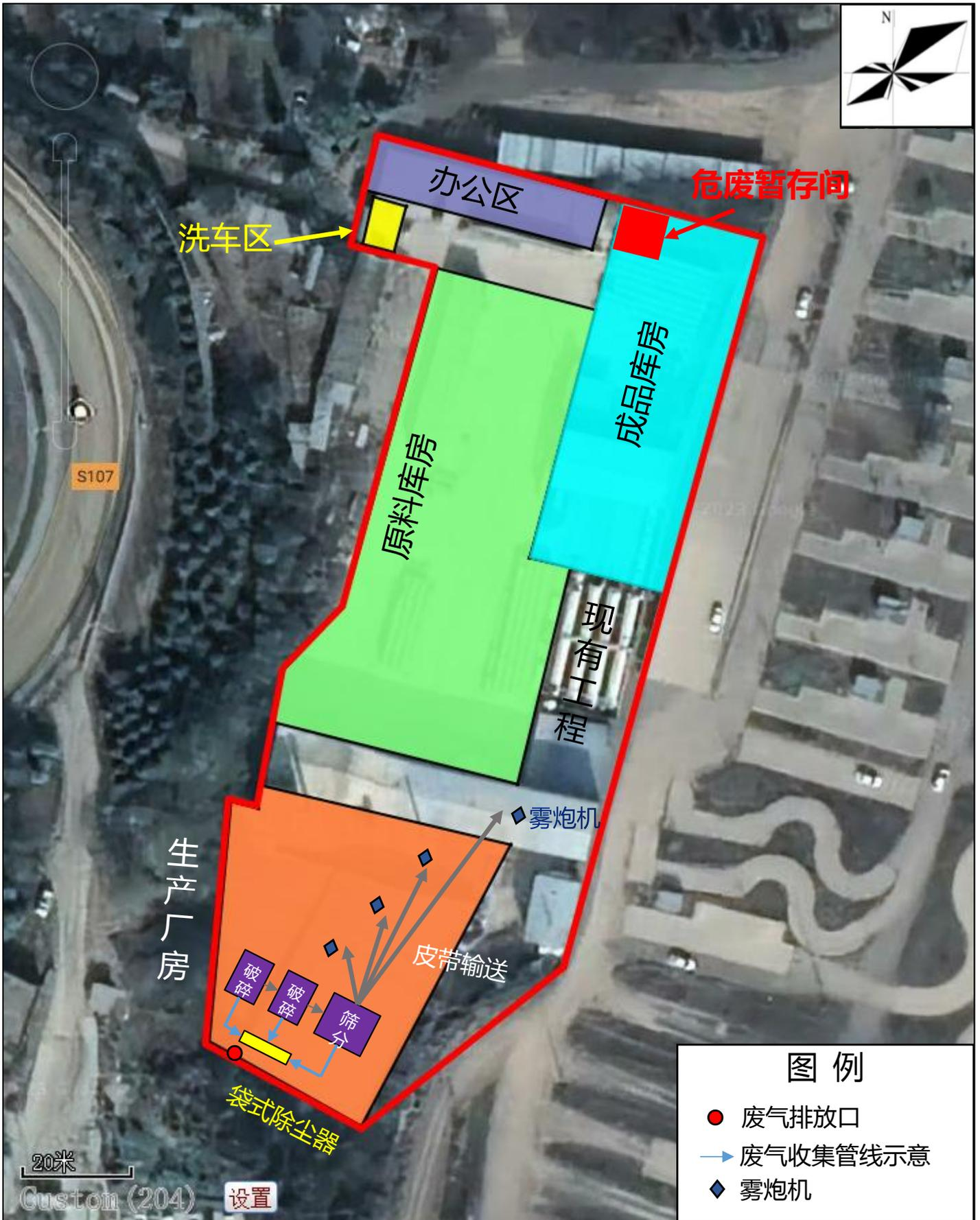
附图四 废气收集、排放示意图
