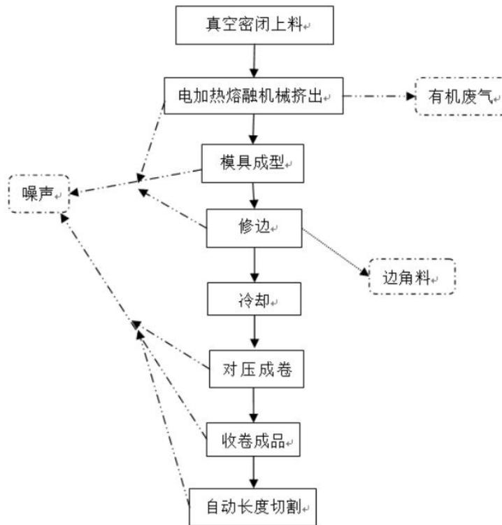
图 2-4 变更前工艺流程及产污环节图
