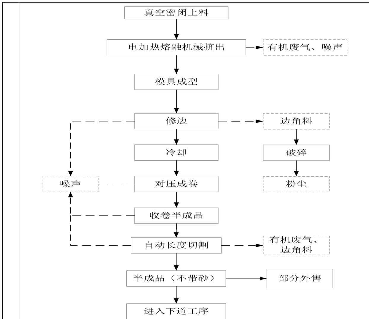
图 2-2 熔融挤出生产工艺流程及产污环节图
