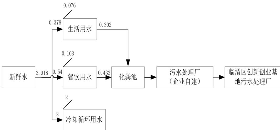
图2-1变更前水平衡图(单位：m<sup>3</sup>/d)
